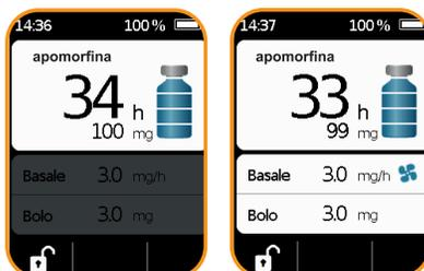
13. Per iniziare l'infusione, premere il pulsante "Inizio" per 3 secondi - le informazioni sulla velocità basale e sul bolo verranno visualizzate sul display. Il simbolo dell'elica rotante indica che la pompa è in funzione.
