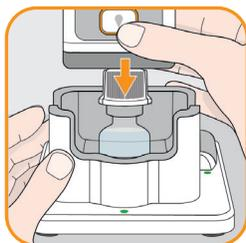
5. Capovolgere la pompa con il reservoir e l'adattatore serrato e fare in modo che scatti verticalmente in posizione sul flaconcino nella stazione di ricarica.
