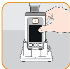
6. Ruotare la pompa in posizione verticale con il flaconcino attaccato e inserirla nella stazione di ricarica. Controllare il posizionamento dell'adattatore ruotandolo in senso orario. Seguire le istruzioni sullo schermo per iniziare il processo di riempimento. Durante il processo di riempimento, la pompa deve rimanere in posizione verticale.
