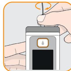
8. Controllare che il raccordo filettato sul reservoir sia ancora pulito. Estrarre un set di infusione compatibile dalla confezione e collegarlo al reservoir della pompa. Serrare a mano la connessione filettata in modo sicuro.
