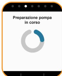
10. Il display della pompa mostrerà il seguente messaggio: "Preparazione pompa in corso" attendere che si concluda la preparazione. La pompa deve rimanere in posizione verticale durante la preparazione.
