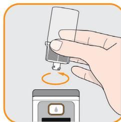
7. Afferrare il flaconcino con l'adattatore e rimuoverli entrambi dal reservoir ruotandoli in senso antiorario. Smaltire questi componenti con i rifiuti domestici secondo la Sezione 9.6 delle Istruzioni per l'uso.
