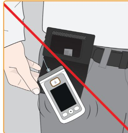
⚠ L'ouverture de la sacoche ne doit jamais pointer vers le bas. La pompe pourrait tomber et être endommagée.
