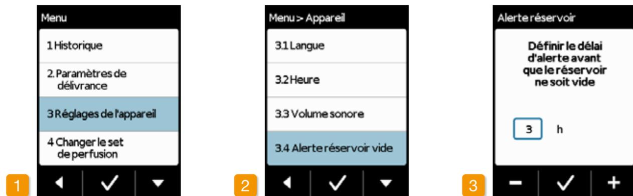
La fonction **Alerte réservoir vide** permet de régler le moment auquel la pompe doit émettre l'avertissement « **Réservoir presque vide** ». La fonction Alerte réservoir vide est le temps restant, à compter de l'apparition du message, avant de devoir changer le réservoir. Lors de ce calcul, le nombre maximal de bolus n'est pas pris en compte.
